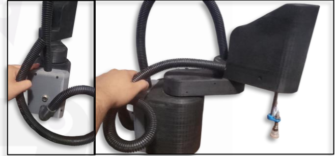
Robot funcional tipo Scara impreso en 3D.
