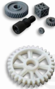
Engranajes y repuestos impresos en 3D.
