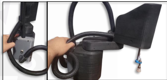
Robot funcional tipo Scara impreso en 3D.
