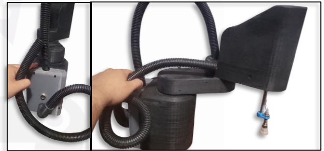
Robot funcional tipo Scara impreso en 3D.
