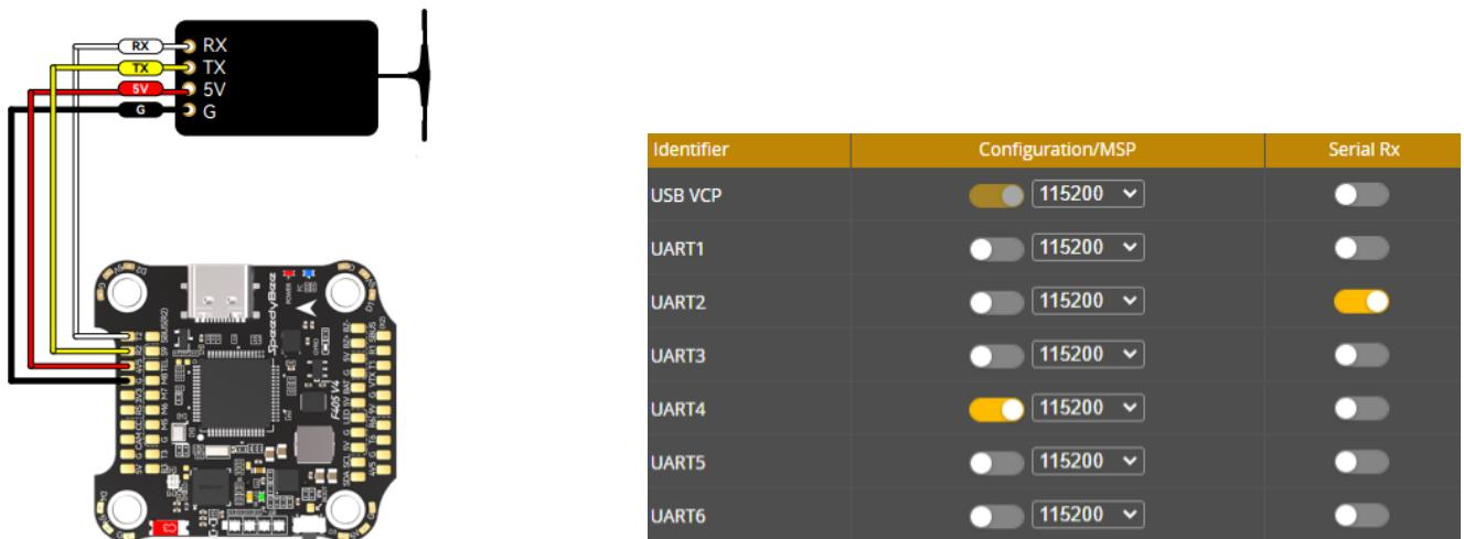
Toliau nueikite į "Receiver" skiltį, kurioje rasite lenteles ir parametrus, kurie nustato Jūsų valdymo pulto parametrus. Atkreipkite dėmesį į "Receiver Mode", kuris turėtų būti Serial (via UART). Taip pat "Serial Receiver Provider" turėtų būti CRSF. Nustačius šiuos parametrus Jums reikia prijungti pultą prie drono.
