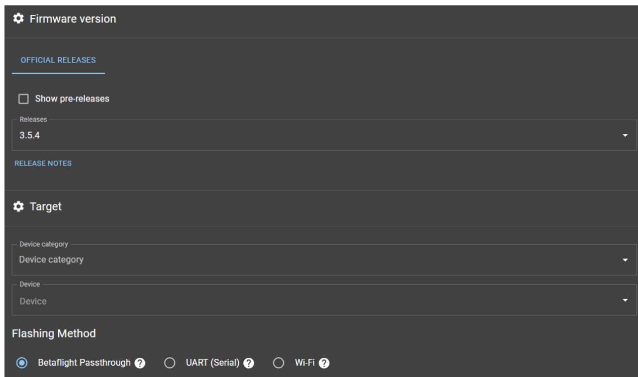
Pasirinkite atitinkamą atnaujinimą. Visada rekomenduojama naudoti pačią naujausią versiją. "Device category" pasirinkite įrenginį, "Device" pasirinkite Imtuvo modelį. Prijunkite drona prie kompiuterio, bet nejunkite Betaflight. Pasirinkite jdiegimo būdą "Flashing Method" per Betaflight "Betaflight Passthrough". Žemiau pasirinkite USB įrenginį "Manual serial device selection" ir spauskite "Flash" mygtuką, kad konfigūratorius atliktų atnaujinimą Jūsų Imtuvui.
