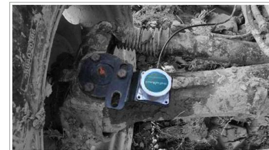
Le capteur d'angle de roue avant peut être installé sur les roues gauche ou droite et doit être installé à un endroit qui peut tourner à gauche et à droite en même temps que le pneu.
