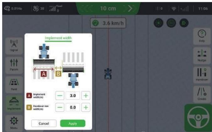
Définir la largeur de la machine et la largeur de la rangée de transfert
