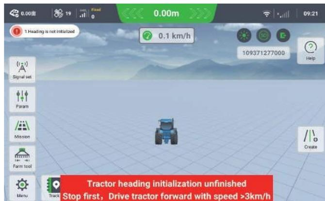
Si le cap n'est pas initialisé lors d'une utilisation ultérieure, veuillez suivre avancez à une vitesse supérieure à 2 km/h jusqu'à ce que l'invite passe à "Initialisation du cap"
