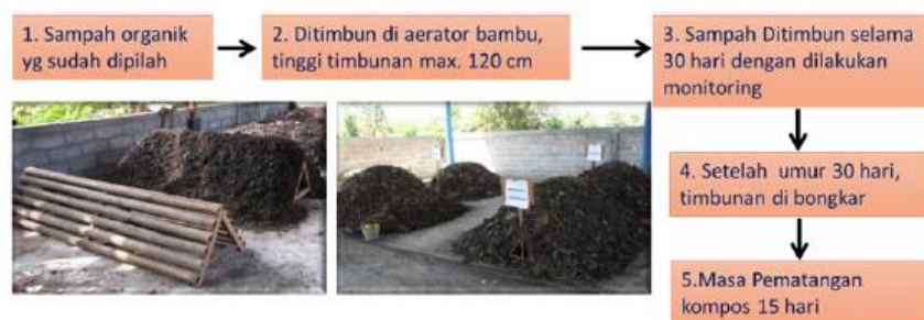
Gambar 3.1. Alur Kerja Pengolahan Aerator Bambu (Sumber: Pedoman Teknis Pelaksanaan TPS 3R, 2021)
