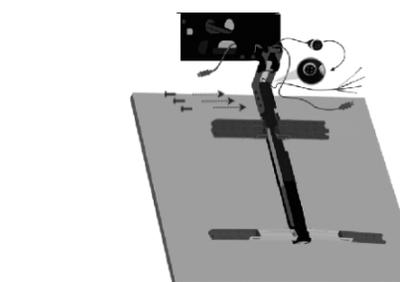
Nota: El tercer y tornillo del motor al brazo solo debe ser apretado una vez desde el prisionero se le da el ajuste perfecto al sistema (se recomienda hacerlo con el televisor ya instalado).
