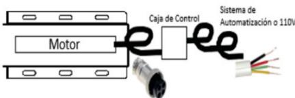
\* El Cable del motor se conecta a caja de control por la parte trasera o lateral de la caja principal.
