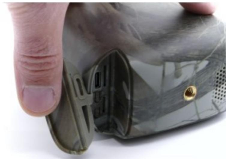
Les caractéristiques techniques incluent une résolution Full HD 2MP, un angle de vision de 110°, une fréquence d'image de 25 ips, une excellente sensibilité à la lumière et permet le stockage sur carte mémoire ou cloud (payant). La caméra détecte les mouvements jusqu'à 8 mètres en moyenne et est alimentée par une batterie lithium rechargeable de 10400mah. Elle est résistante aux intempéries (IP65) et fonctionne dans une large gamme de températures et d'humidité.
