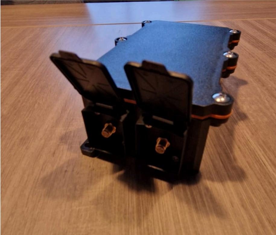
Nous parlons donc d'une caméra intégrée dans une petite bûche de bois à placer dans le décor. Au bout de cette caméra, un câble de petit diamètre mesurant une dizaine de mètres afin de le dérouler le long d'un arbre ou de l'enterrer. Ce câble se relie au boîtier routeur où vous avez le choix : Une ou deux entrées de caméras (ici deux).
