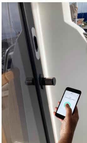
Sur les yachts, chaque détail compte. Notre adaptateur spécialement conçu pour les serrures Southco transforme l'intégration du verrou électronique OCM2122 - IP66 - en un ensemble harmonieux, précis et parfaitement adapté aux contraintes marines.
