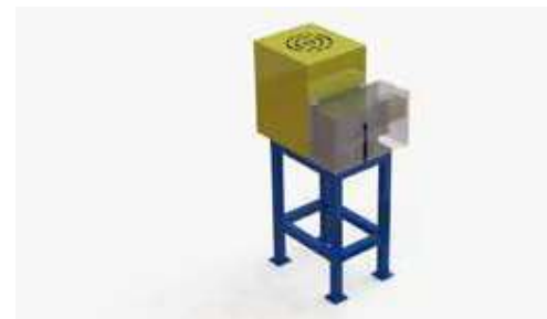
MÁQUINA DE LIMPEZA DE TUBO APÓS CORTE A PLASMA.
