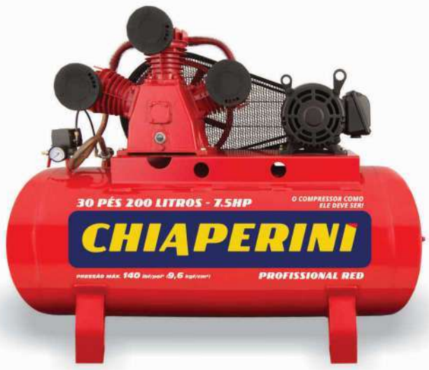
30/200 RED - 200L - 7.5HP - 2P 3 Cilindros em V 1 estágio - 140 lbf/pol 2 CÓD. 21275 trifásico 220/380V IP21 (aberto)
