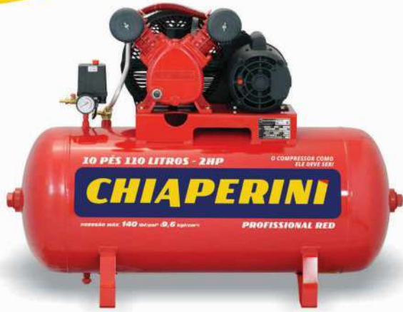
10/110 RED - 110L - 2HP - 2P 2 Cilindros em V 1 estágio - 140 lbf/pol 2 CÓD. 19195 Monofásico 110/220V IP21 (aberto) CÓD. 19751 Trifásico 220/380V IP21 (aberto)
