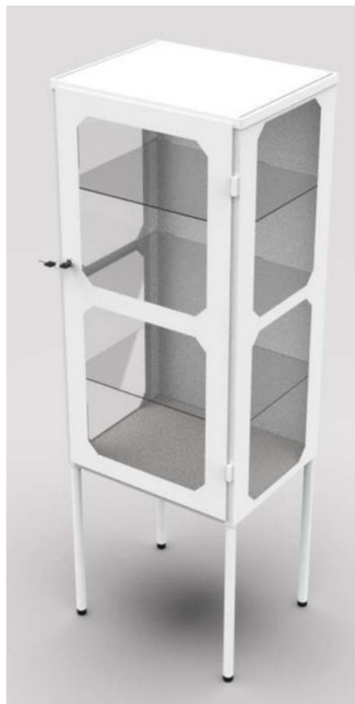
**ESTRUTURA:** Teto e Base do armário fabricados em Aço SAE 1020, chapa # 20 (0,90 mm de espessura), Fundo do armário fabricado em Aço SAE 1020, chapa # 24 (0,60 mm de espessura), e, Porta do armário fabricada em Aço SAE 1020, chapa # 18 (1,20 mm de espessura).
