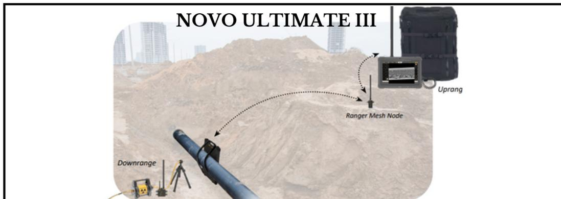
El Ultimate III fue especialmente diseñado para empacar los detectores NOVO 22WS o 15WS y mantener el peso y el tamaño del sistema al mínimo posible. Además de los detectores de NOVO, esta pequeña mochila permite el embalaje de la caja de control conectada a la fuente Golden Engineering XRS-3, tablet de 10" y accesorios en una configuración muy pequeña y compacta, dando la máxima flexibilidad en el paquete más pequeño.
