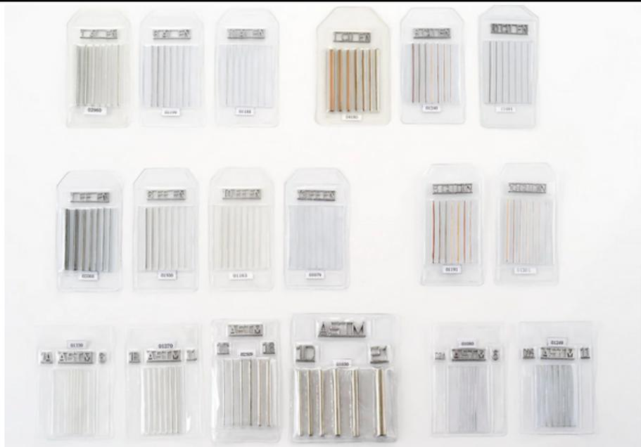
Estos Wire Tipo IQI's están encapsulados en vinilo para mayor durabilidad. Disponible en 4 tamaños (Sets A, B, C y D) e inspeccionados con instrumentos calibrados y trazables al Instituto Nacional de Estándares y Tecnología (NIST). Los IQI's de tipo wire ASTM E747 se fabrican con 6 alambres en cada tamaño
