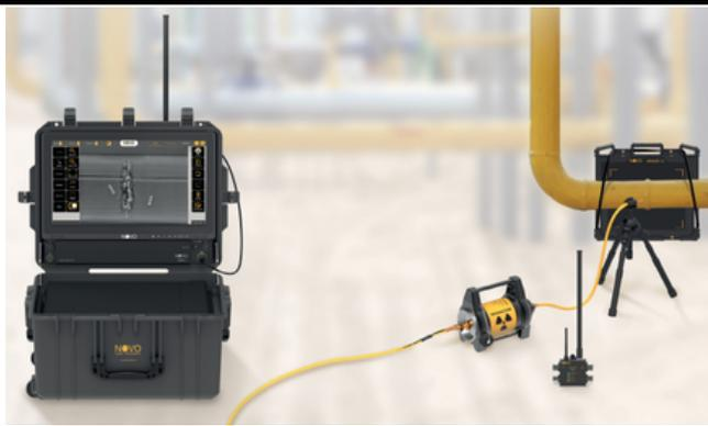
A diferencia de la película radiográfica o la radiografía computarizada (CR), la radiografía digital (DR) utiliza un dispositivo de captura de imágenes digitales de Rayos X (Detector Plano).
