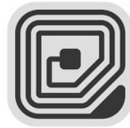
圖 1 RFID 晶片被天線所包圍
