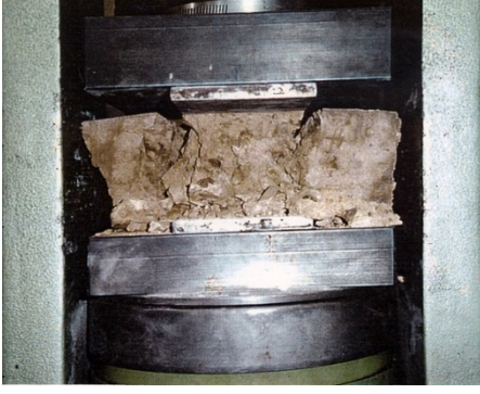
Şekil 13 - Katkısız örnekler Basınç deneyinde dağılıyor.
