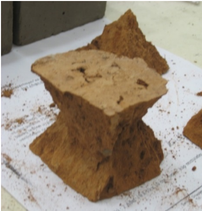
Şekil 12- Erozyon deneyinde, örnekler kurutulduktan sonra yapılan basınç dayanımı deneyinde mekanik niteliklerde kaybı olmadığı, deney sonucunda, yük alan normal beton gibi, dağılmadan ikiz piramit şeklinde kırıldığı görülüyor.
