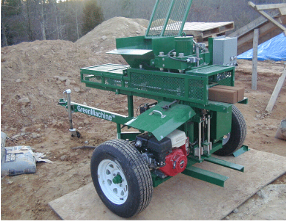
Şekil 16 - Küçük şantiyelere de götürülebilen, seri blok üretimi yapılan araçlardan bir örnek ( http://web.ornl.gov/sci/roofs+walls/AWT/HotboxTest/AdobeEarth/TerraBuilt/ )
