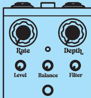
**Rate** - Ajusta a velocidade do efeito. Gire para a direita para aumentar a velocidade e para a esquerda para reduzir.
