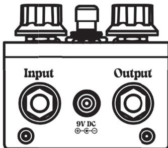
**INPUT** - Conecte seu instrumento aqui.
