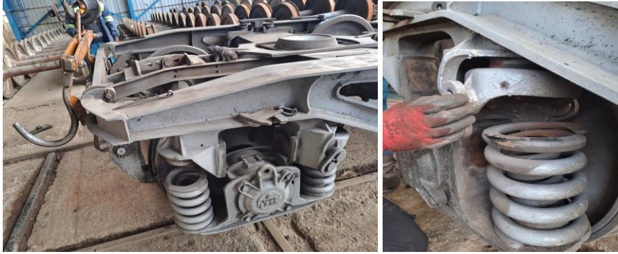
Şekil 11. Bojideki helezon sustaların sökölmesi ve montajı
