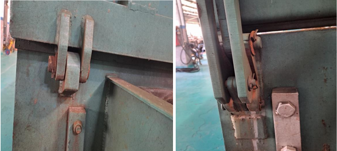
Şekil 18. Platform tipi vagonlarda alın kapak deęiřimi
