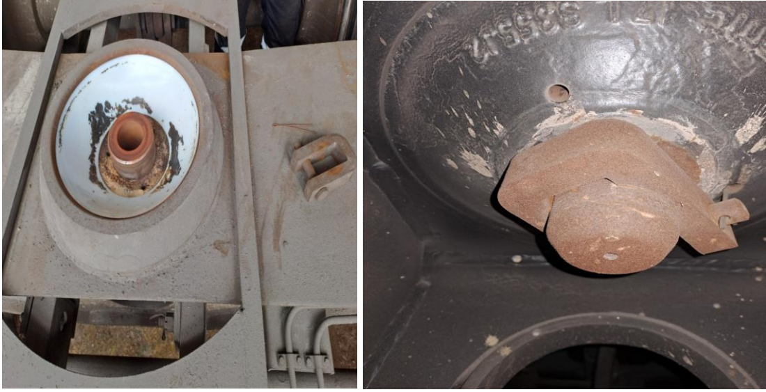
Şekil 7. Yük vagonlarının şase ile bojilerinin birleştirilmesi
