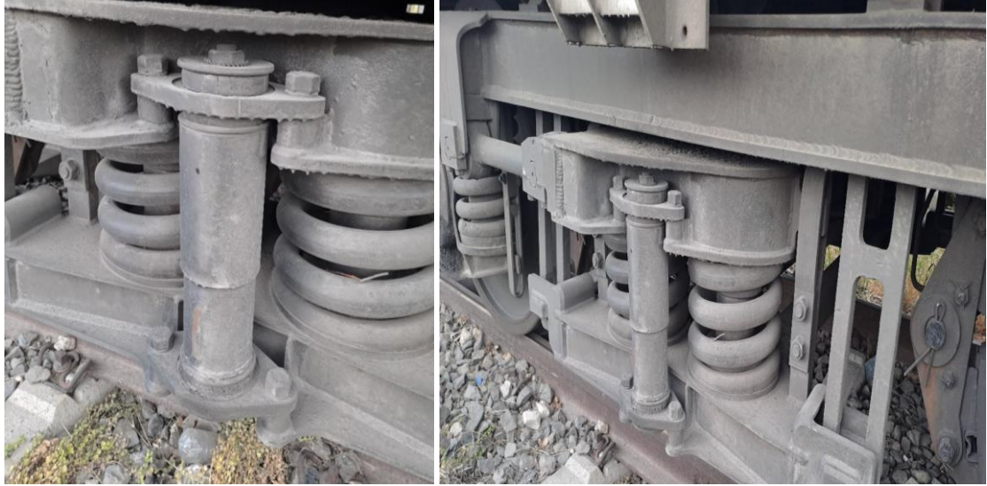
Şekil 15. Amortisörlerin sökülmesi ve montajı
