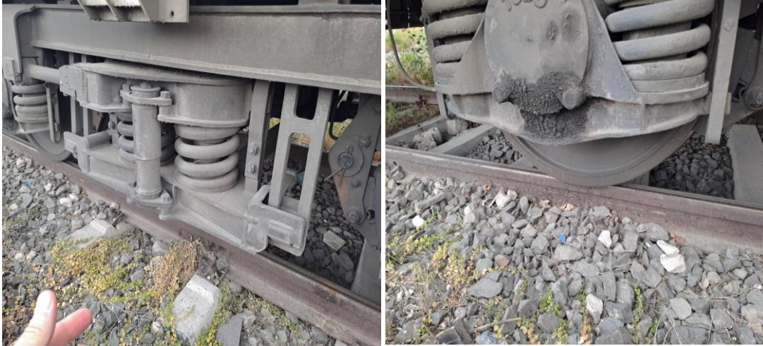
Şekil 13. Scheleren bojideki helezon sustaların sökülmesi ve montajı
