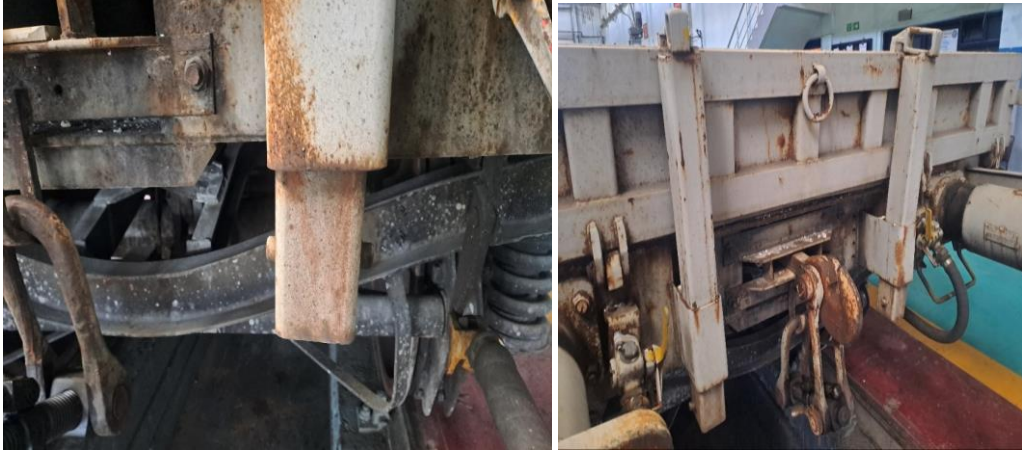
Şekil 17. Platform tipi vagonlarda alın kapak dikmesi deęiřimi
