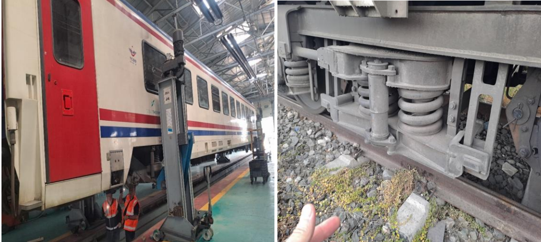
Şekil 1. Yolcu vagonlarının bojilerinin vagondan ayrılması
