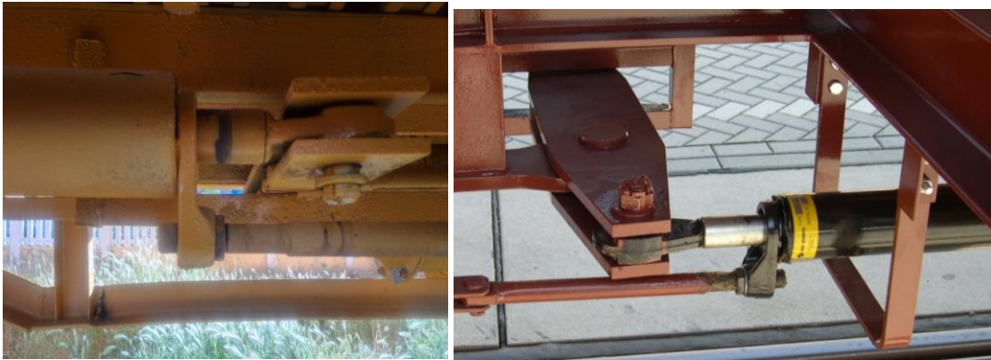
Şekil 28. Piston tiji reglaj (sia) ayarı
