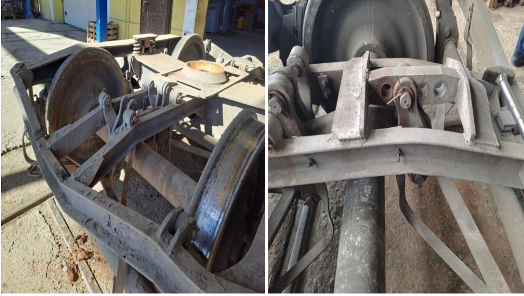
Şekil 3. Bojilerden tekerlek takımlarının ayrılması
