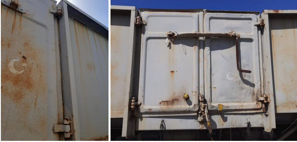
Şekil 21. Yüksek kenarlı vagonlarda yan kapak değişimi
