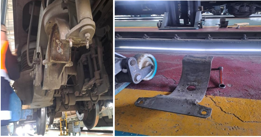
Şekil 4. TVS tipi vagonlarda bojiler sökülmeden tekerlek takımlarının ayrılması
