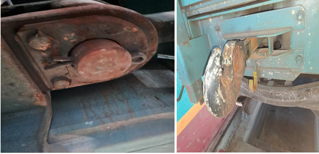
Şekil 9. Cer kancasının sökölmesi ve montajı
