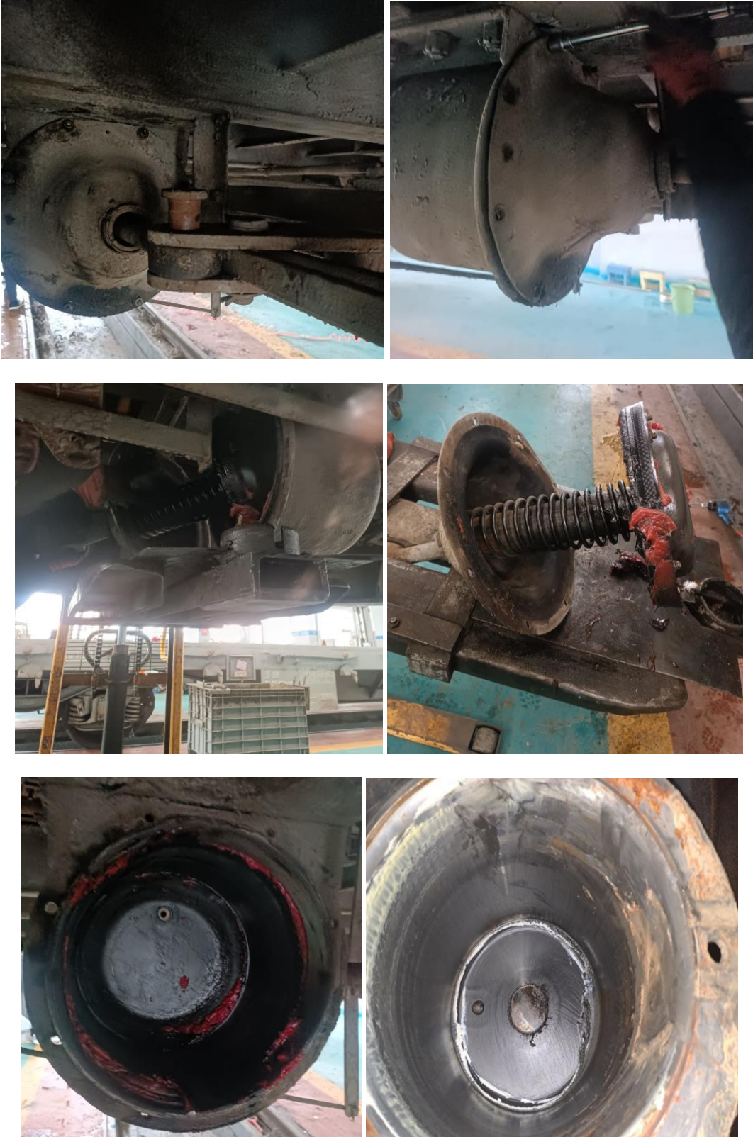
Şekil 25. Fren silindir bakımı ve conta deęiřimi
