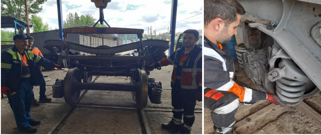
Şekil 5. Bojili vagonlarda tekerlek takımlarının birleştirilmesi
