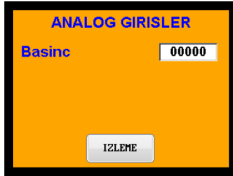
Şekil 112. Atık su tankı PLC analog girişler ekranı
