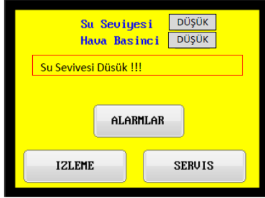
Şekil 111. Atık su tankı PLC ana sayfa ekranı
