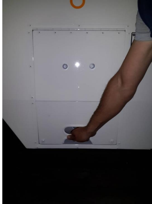
Şekil 121. Su doldurma ve katı atık tankı boşaltım kapağı
