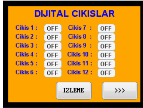
Şekil 113. Atık su tankı PLC dijital çıkışlar ekranı
