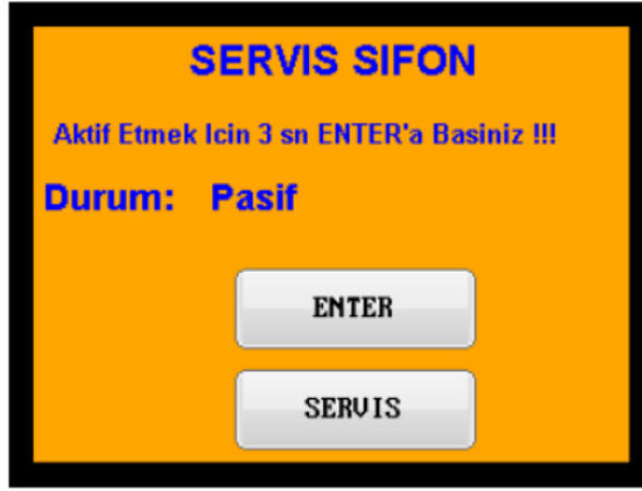
Şekil 115. Atık su tankı PLC servis sifon ekranı
