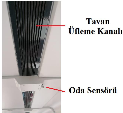
Şekil 77. Salon tavadaki oda sensörü ve tavan üfleme kanalı
