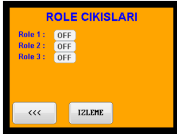
Şekil 114. Atık su tankı PLC röle çıkışları ekranı
