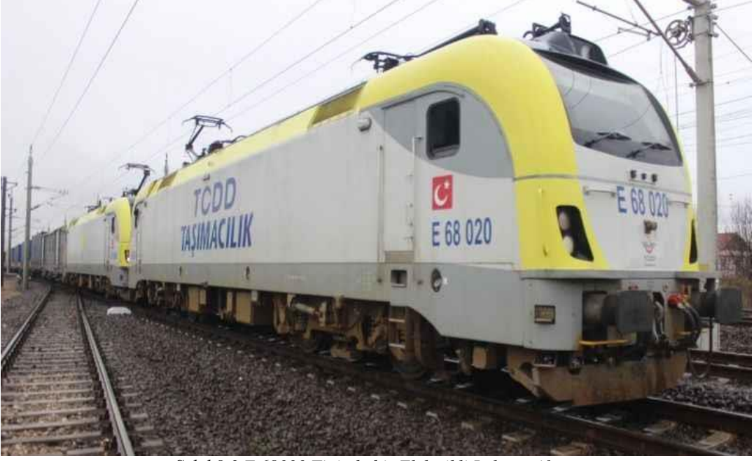
Şekil 8.3 E 68000 Tipinde bir Elektrikli Lokomotif
