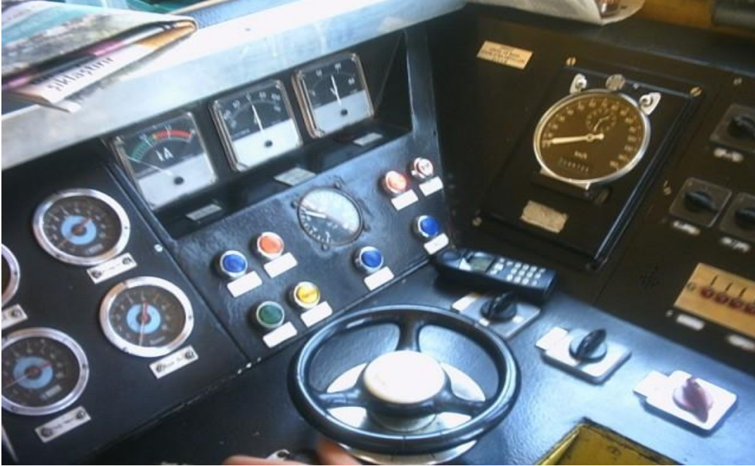
Şekil 11.2 DE 24000'lik lokomotif'e ait kumanda masasında bulunan göstergeler
