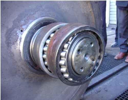
Şekil 17.3 Dingil yatağı ve dingil kutusu (kapağı sökülmüş)
