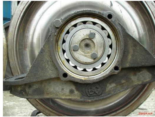
Şekil 17.3 Dingil yatağı ve dingil kutusu (kapağı sökülmüş)
