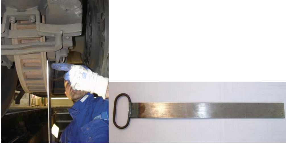
Şekil 47. Balatanın disk boşluğunun kontrolü [4]
