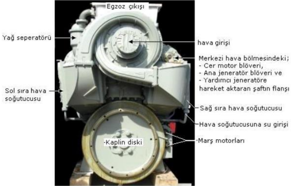
Şekil 47- Turbo kompresör
