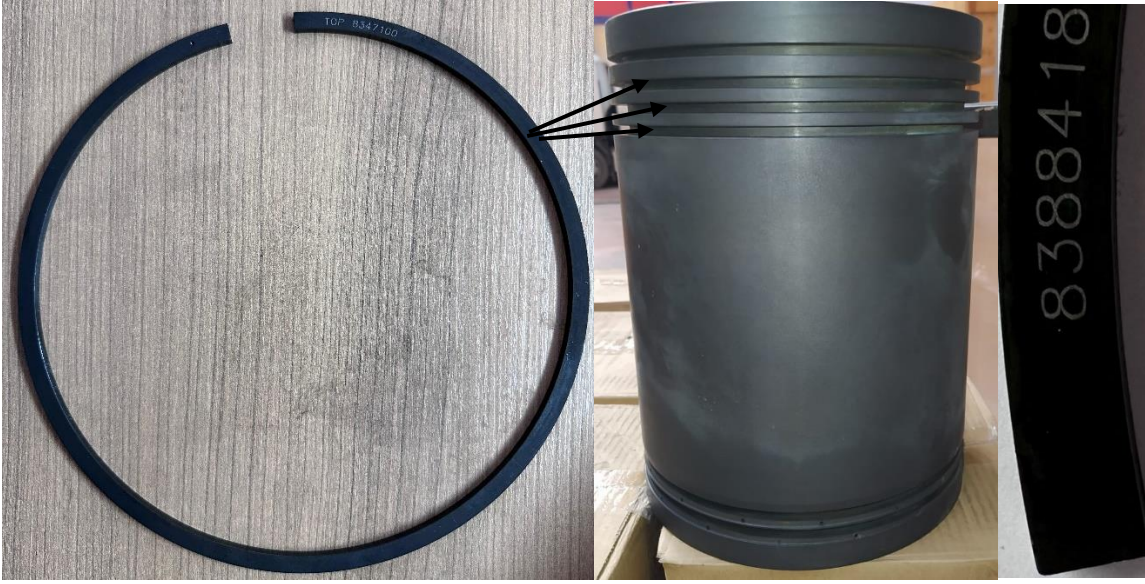
Şekil 27- 2. ve 3. ve 4. sıkıştırma segmanlarının piston üzerine montajı
