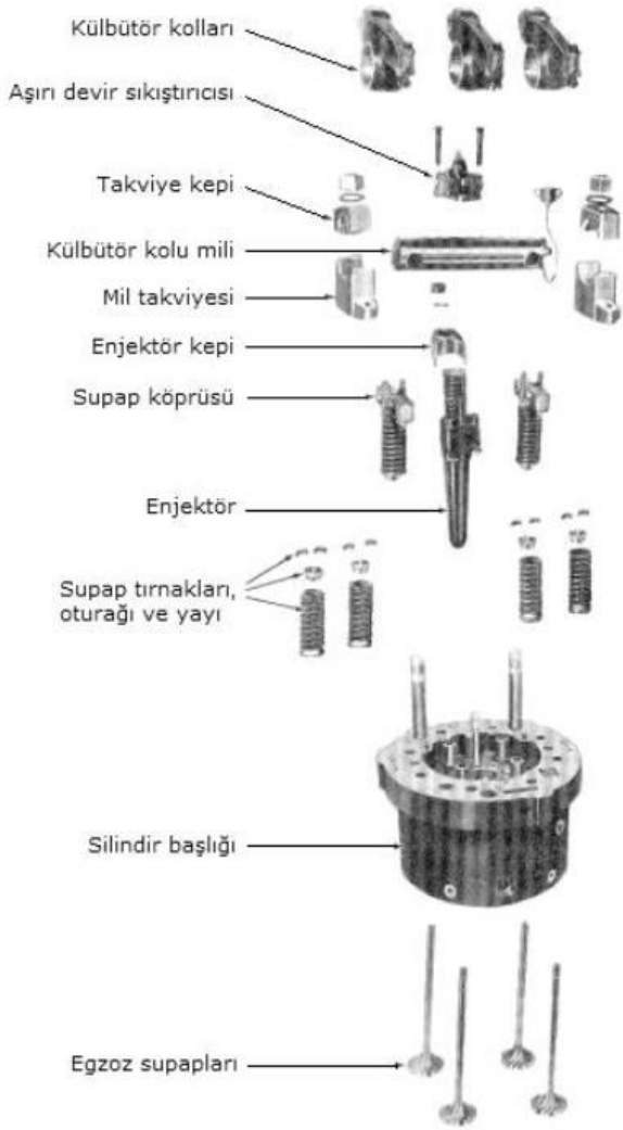
Şekil 19- Silindir başlığı kompleksi yaygın görünüşü
