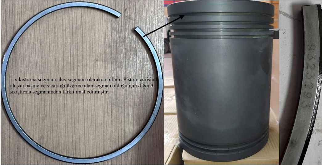
Şekil- 25 1. Sıkıştırma(Alev) segmanının piston üzerindeki montajı
