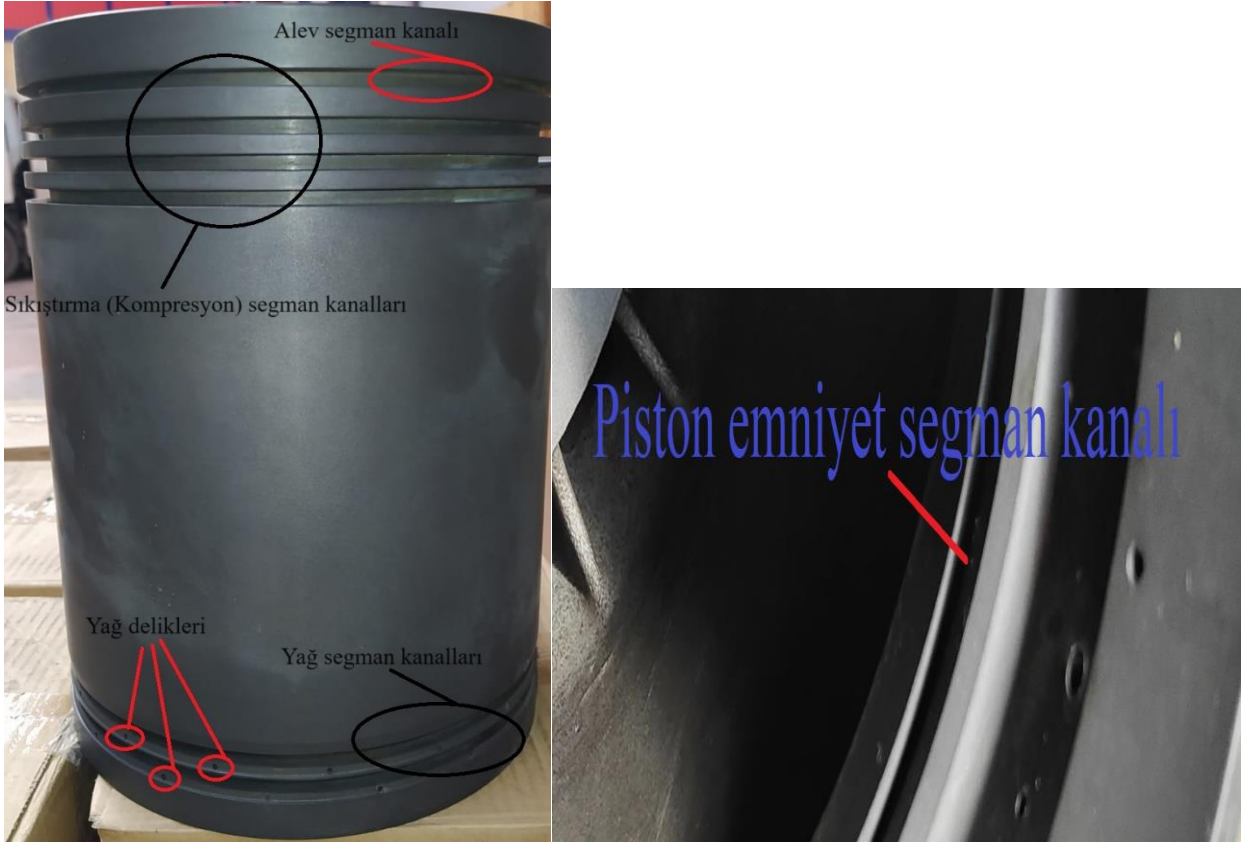
Şekil 23- 645E tipi motor piston üzerindeki segman kanalları
