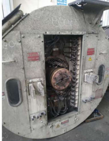
Şekil 8. DE 33000 tipi lokomotif ana alternatörünün bileziği, kabloları, fırçalıkları ve redresörü
