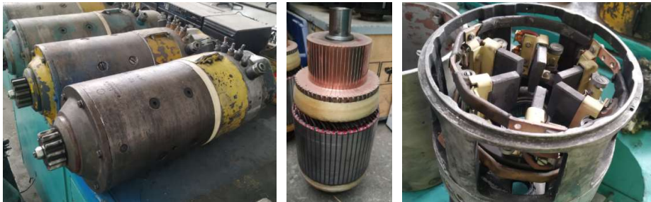
Şekil 24. DE 24000 tipi lokomotif marş motoru ve parçaları (endüvisi, fırçalığı ve kömürleri)
