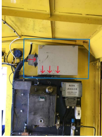
Şekil 194. DE 24000 tipi lokomotif ikili kumanda sistemi kumanda panosu
