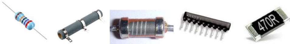
Şekil 42. Sırasıyla; karbon, telli, film, entegre ve smd (yüzey montajlı) direnç örnek görselleri
