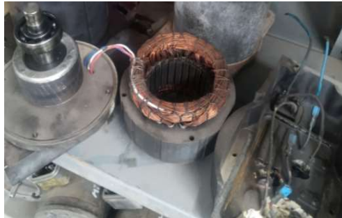
Şekil 31. DE 33000 tipi lokomotif ön yağlama motoru ve parçaları
