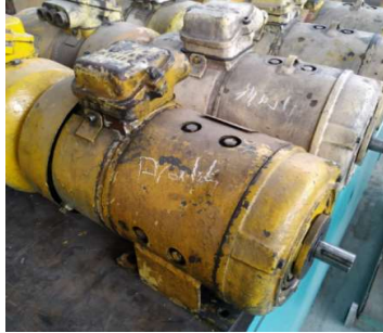
Şekil 30. DE 24000 tipi lokomotif ön yağlama motoru ve endüvisi
