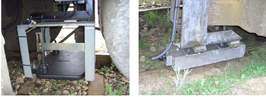
Şekil 184. ATS sistemi parçalarından; araç üstü magnetleri
