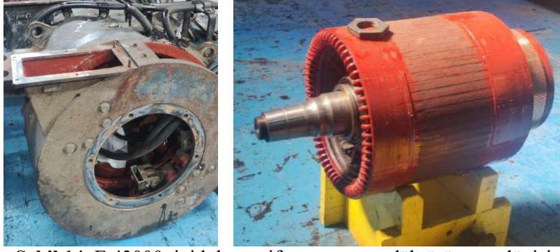
Şekil 14. E 43000 tipi lokomotif cer motor endüktörü ve endüvisi
