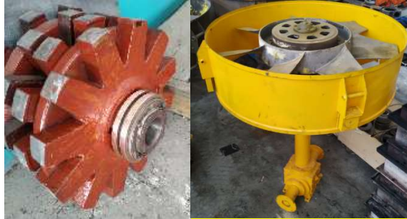
Şekil 22. DE 24000 tipi lokomotif soğutucu fan bobini (bileziği ve nüvesiyle) ve komple fan
