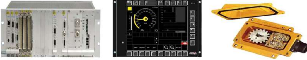
Şekil 208. ERTMS araç üstü ekipmanlarından EVC, DMI ve odometre [26]
