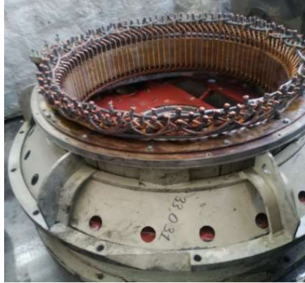
Şekil 16. DE 33000 tipi lokomotif ikaz alternatörü statoru
