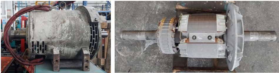
Şekil 19. DE 22000 tipi lokomotif yardımcı alternatörü ve rotoru
