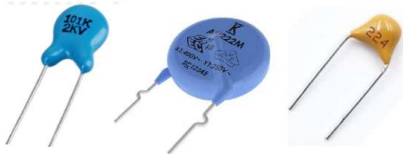
Şekil 54. Seramik kondansatör örnek görselleri
