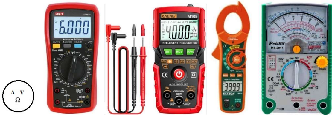
Şekil 212. Multimetre sembölü ve örnek görselleri
