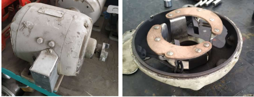
Şekil 27. DE 22000 tipi lokomotif yakıt ikmal motoru ve fırçalığı
