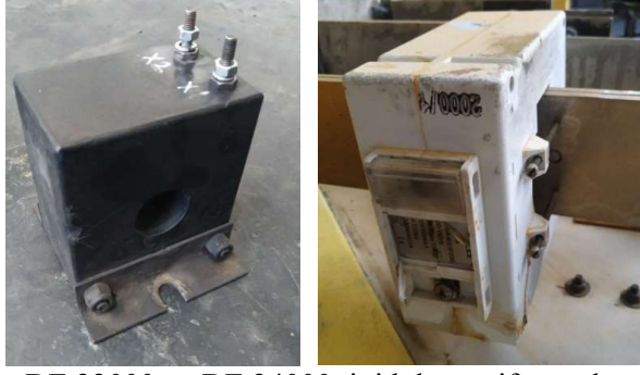
Şekil 34. Sırasıyla; DE 22000 ve DE 24000 tipi lokomotif ana alternatör akım trafoları
