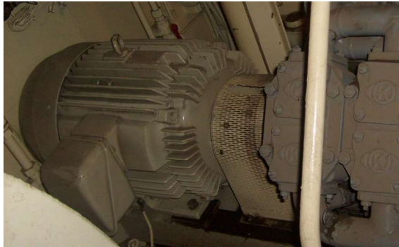
Şekil 36. E 43000 tipi lokomotif için kompresör tahrik motoru
