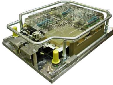
Şekil 91. E 68000 tipi lokomotif IGBT invörtör bloğu [2]
