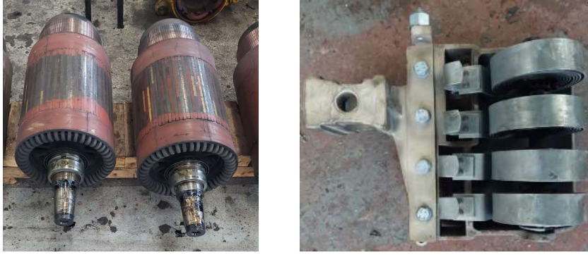
Şekil 10. DE 24000 tipi lokomotif cer motor endüvisi ve fırçalığı
