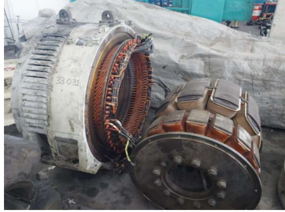
Şekil 7. DE 33000 tipi lokomotif ana alternatör statoru ve rotoru
