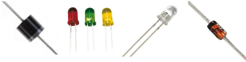
Şekil 64. Sırasıyla; normal, led, foto ve zener diyot örnek görselleri
