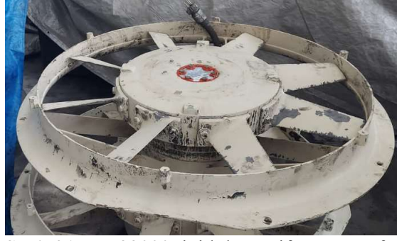
Şekil 21. DE 22000 tipi lokomotif soğutucu fan
