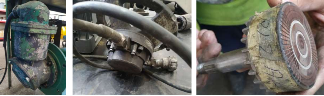
Şekil 37. Sırasıyla; DE 24000 ve DE 22000 tipi lokomotif aks alternatörü ve DE 22000 tipi için rotoru
