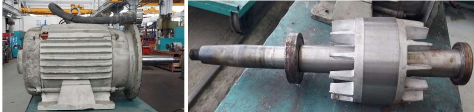
Şekil 26. DE 22000 ve DE 33000 tipi lokomotif ataletli filtre motoru ve rotoru
