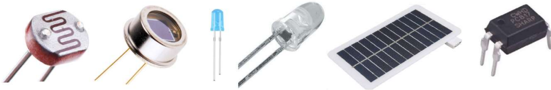
Şekil 108. Sırasıyla; LDR, foto diyot, LED, IR LED, güneş pili ve optokuplör örnek görselleri
