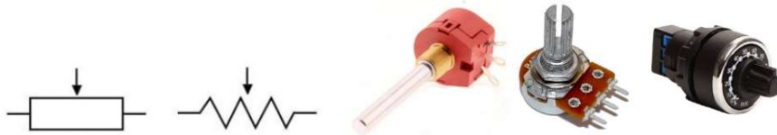
Şekil 44. Potansiyometre sembolü ve örnek görselleri
