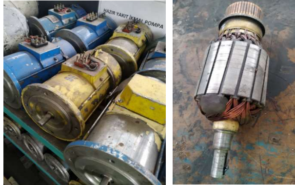
Şekil 28. DE 24000 tipi lokomotif yakıt ikmal motorları ve endüvisi
