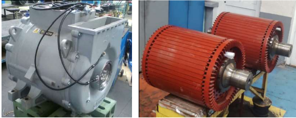
Şekil 15. E 68000 tipi lokomotif cer motoru ve rotorları
