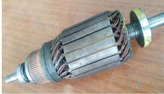
Şekil 30. DE 24000 tipi lokomotif ön yağlama motoru ve endüvisi
