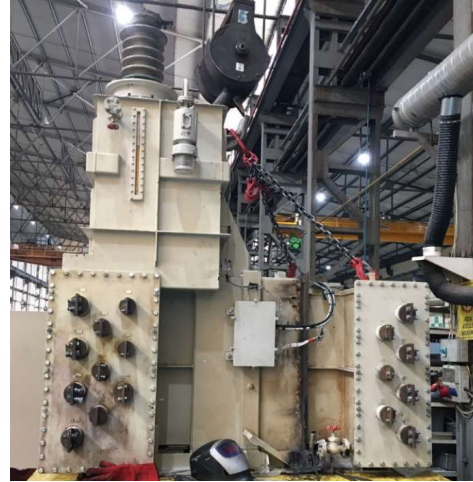
Şekil 33. Sırasıyla; E 68000 ve E 43000 tipi lokomotiflere ait transformatörler
