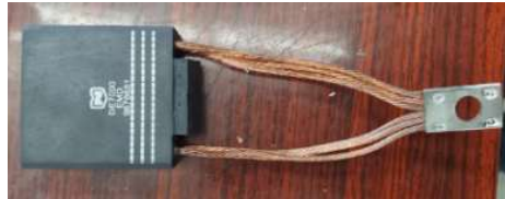
Şekil 13. DE 22000 tipi lokomotif cer motor fırçalıkları ve kömürü
