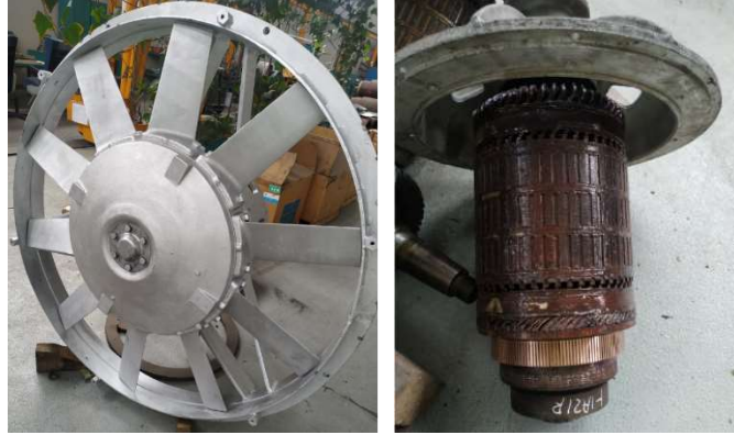
Şekil 23. DE 22000 tipi lokomotif dinamik fren fan motoru ve endüvisi
