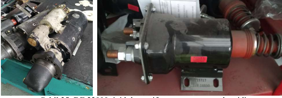
Şekil 25. DE 22000 tipi lokomotif marş motoru ve selenoidi
