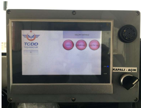
Şekil 195. DE 24000 tipi lokomotif ikili kumanda sistemi ekranı
