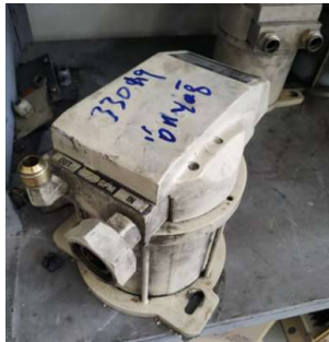
Şekil 31. DE 33000 tipi lokomotif ön yağlama motoru ve parçaları
