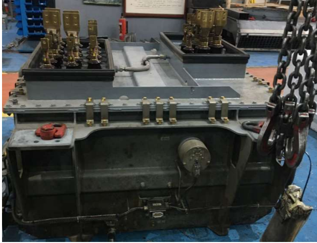
Şekil 33. Sırasıyla; E 68000 ve E 43000 tipi lokomotiflere ait transformatörler
