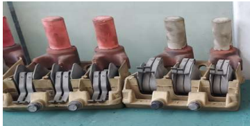
Şekil 13. DE 22000 tipi lokomotif cer motor fırçalıkları ve kömürü
