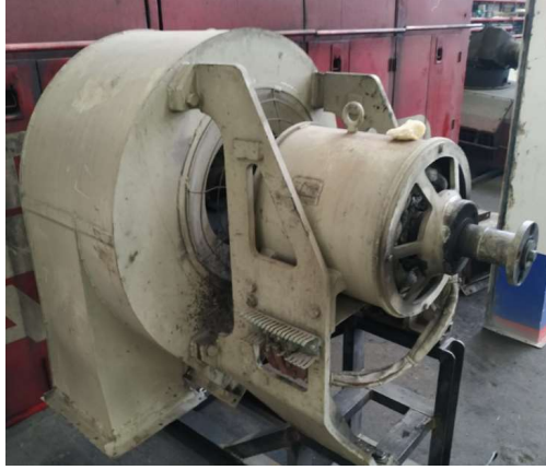
Şekil 20. DE 33000 tipi lokomotif yardımcı alternatör (üfürücü fan ile birlikte)
