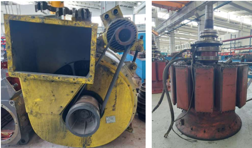
Şekil 5. DE 24000 tipi lokomotif ana alternatörü ve rotoru
