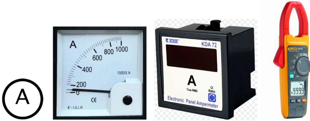
Şekil 210. Ampermetre sembolü ve örnek görselleri
