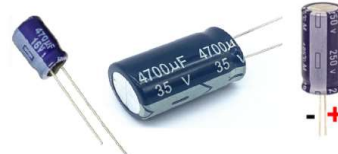
Şekil 55. Elektrolitik kondansatör örnek görselleri
