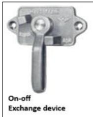
neizravno pomoću uređaja za prebacivanje otvoreno-zatvoreno. Oni su povezani polugom s uređajem za zaključavanje i mogu se upravljati s obje strane vagona. Prednost uređaja za uključivanje i isključivanje je u tome što je lako vidjeti izvan vagona je li kočnica na stlačeni zrak otvorena ili poništена. Ako je poluga okomita prema dolje, kočnica je uključena. Ako je poluga paralelna s tračnicom, kočnica je poništена.
