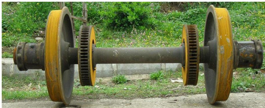
*Slika 15.2 Osovinski sklop vagona tipa TVS 2000*
