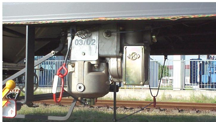
Slika 19.6 Troputni s ugrađenim relajnim ventilom za opterećenje
