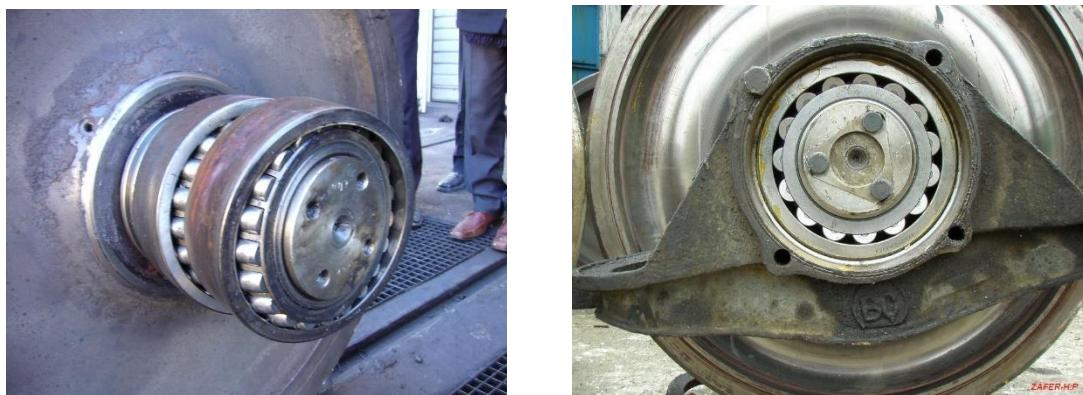
Slika 15.3 Ležaj osovine i kućište osovine (uklonjen poklopac)
