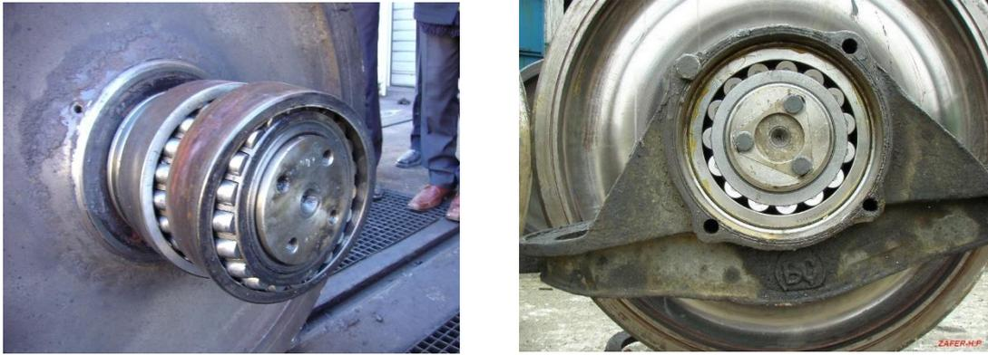
Abbildung 15.3 Achslager und Achslagergehäuse (Deckel entfernt)
