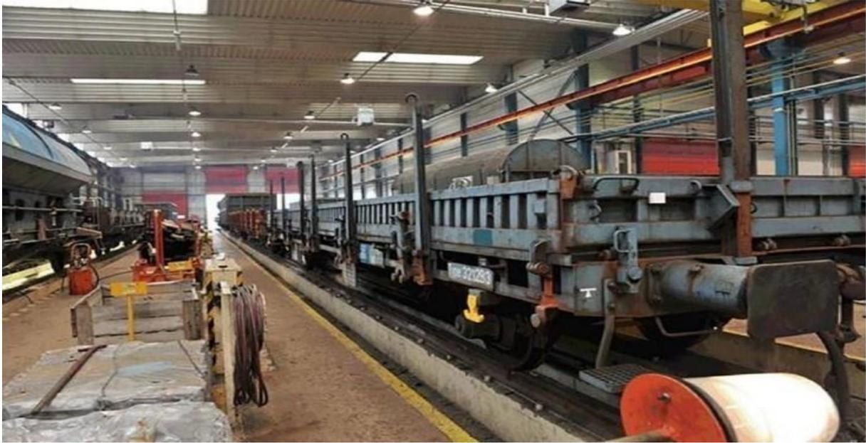
*Abbildung 12.1 Eine Werkstatt zur Instandhaltung und Reparatur von Güterwagen im Rahmen der Instandhaltungsversorgung*
