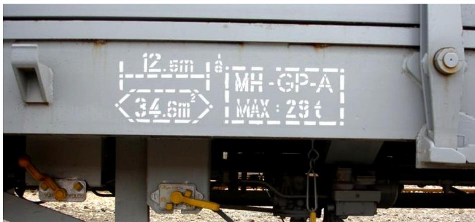
Abbildung 19.7 Beispielhafte Beschriftungen auf dem Waggon
