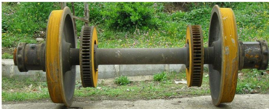
Abbildung 15.2 Radsatz eines Wagens der Bauart TVS 2000
