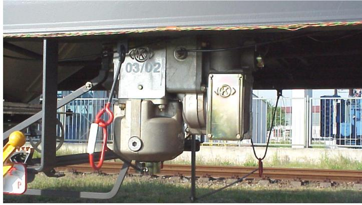
Abbildung 19.6 Triblivalve und montiertes Lastrelaisventil
