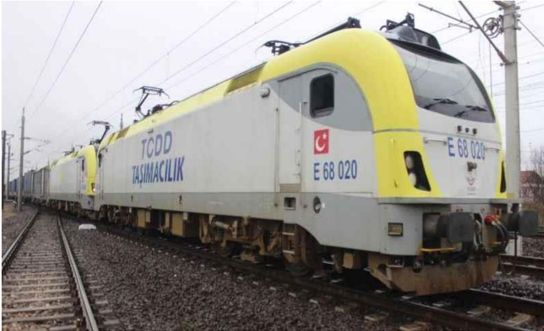
Abbildung 8.3 Eine elektrische Lokomotive des Typs E 68000
