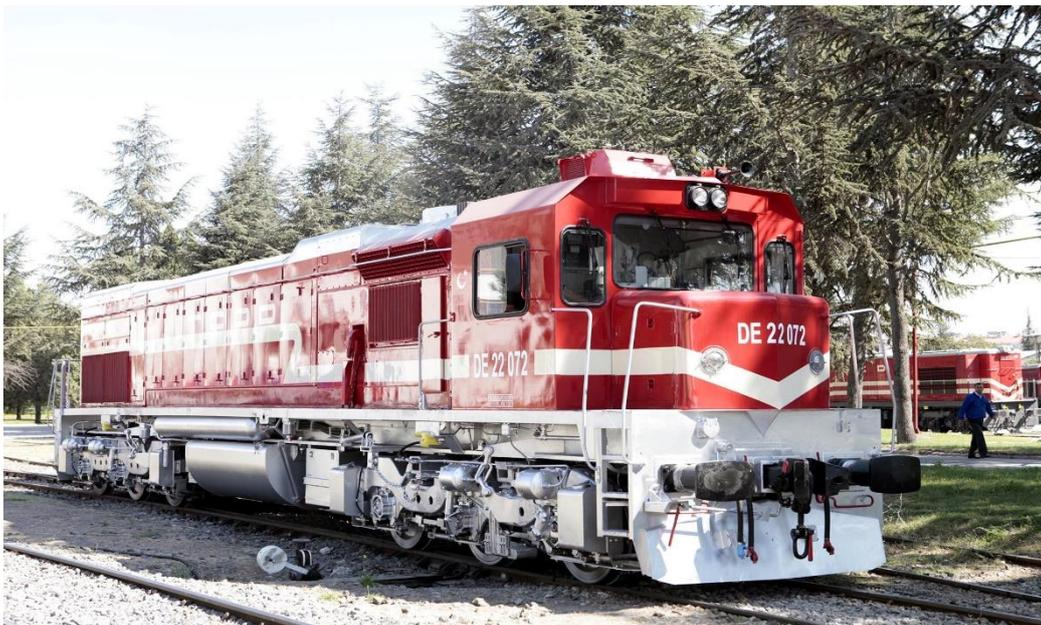
Abbildung 8.2 Eine dieselelektrische Lokomotive vom Typ DE 22000
