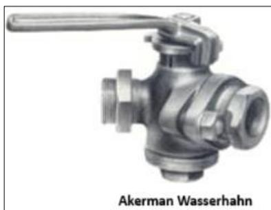
An jedem Ende des Wagens befinden sich Luftabsperrhähne eines bekannten und geschätzten Typs. Der drehbare Teil des Hahns ist kugelförmig und drückt in der geschlossenen Stellung auf eine Gummischeibe, die die Leitung sicher verschließt. Gleichzeitig wird die Luft im Bremsspeicher über den Gummiventilsitz abgelassen. In diesem Fall kann beim Schließen der Hähne die Leitung gefahrlos gelöst werden, da in den Leitungsschläuchen zwischen den beiden Waggons
