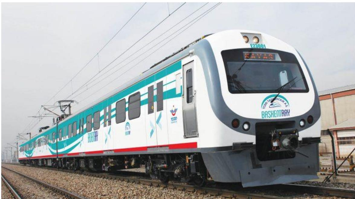
Abbildung 8.4 Ein elektrischer Triebzug des Typs E 23000
