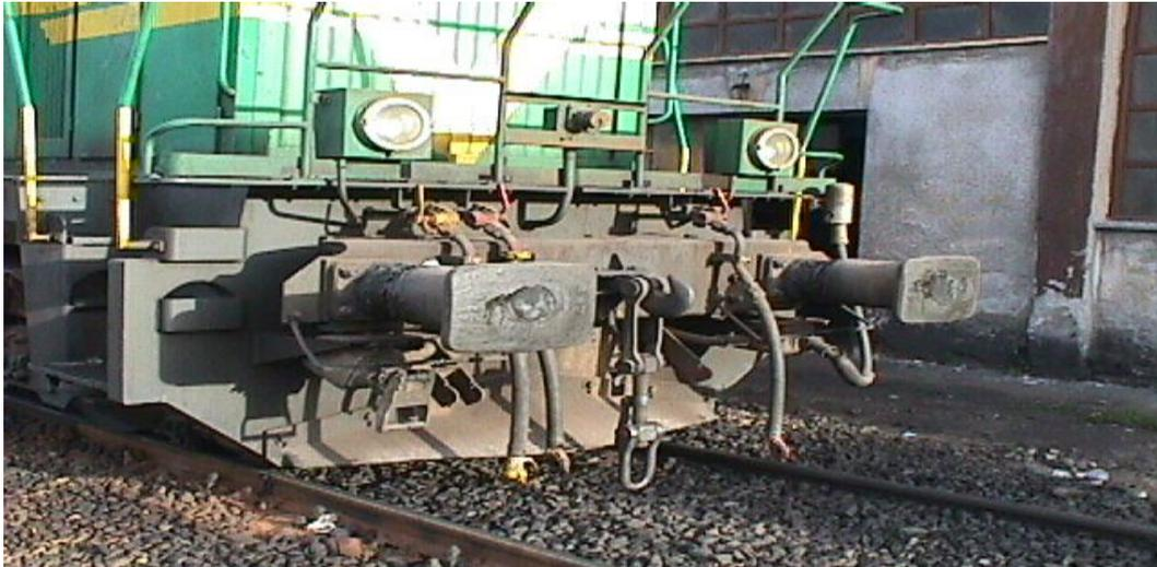
*Abbildung 9.2 Puffer der Lokomotive Typ DE 11000*
