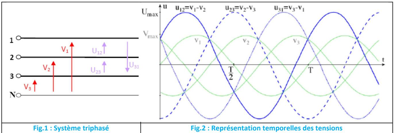
Fig.1 : Système triphasé
