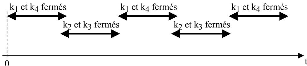
**Alimentation directe du four (le condensateur C étant supprimé) ;  $f = 600$  Hz.**
