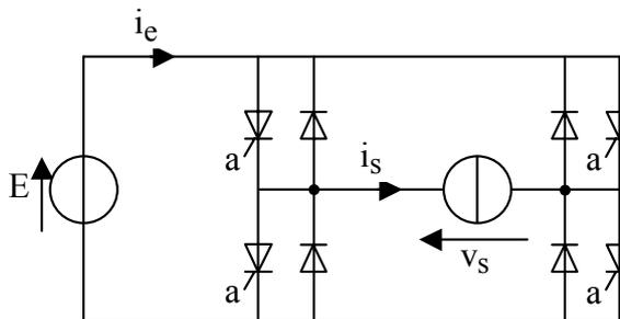
Chaque interrupteur peut être réalisé avec un thyristor associé à une diode en antiparallèle. Il peut également être réalisé avec un transistor équipé d'une commande automatique de blocage lors de l'annulation du courant le traversant, associé à une diode en antiparallèle.
