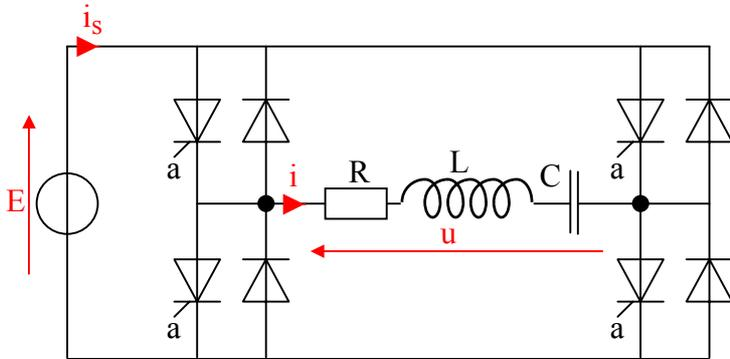
Chaque interrupteur peut être réalisé avec un thyristor associé à une diode en antiparallèle. Il peut également être réalisé avec un transistor (ou un IGBT) équipé d'une commande automatique de blocage lors de l'annulation du courant le traversant, associé à une diode en antiparallèle.
