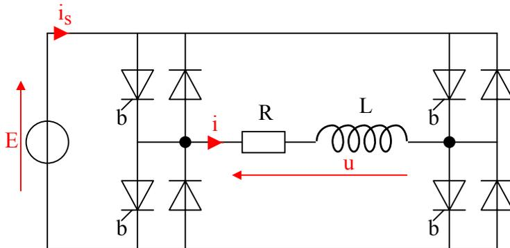
Chaque interrupteur peut être réalisé avec un transistor (ou un IGBT) équipé d'une commande automatique d'amorçage lors de la conduction de la diode en antiparallèle.
