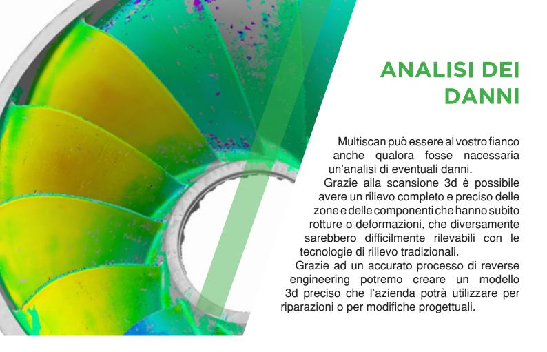
Anche nel caso delle turbine idrauliche la scansione 3D si dimostra un utile strumento per monitorare l'avanzamento di fenomeni corrosivi dovuti allo sfregamento di particelle o a fenomeni cavitativi.
