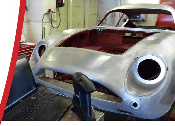
A seconda della precisione richiesta si possono utilizzare differenti tecnologie: un rilievo effettuato tramite laser scanner volto a realizzare una precisa fotografia 360 gradi per ogni singola scansione, il che si dimostra particolarmente adatto per scopi di rilievo del patrimonio e riproduzione digitale per musei, archivi o altri utilizzi digitali.
