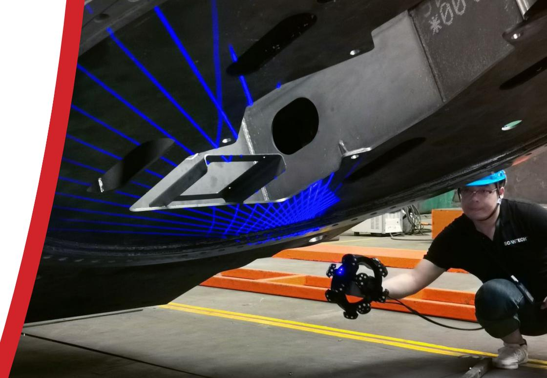
Tramite l'utilizzo della scansione 3D e di strumenti con tolleranze fino a 2 centesimi di millimetro siamo in grado di assistere al montaggio di componenti e impianti.
