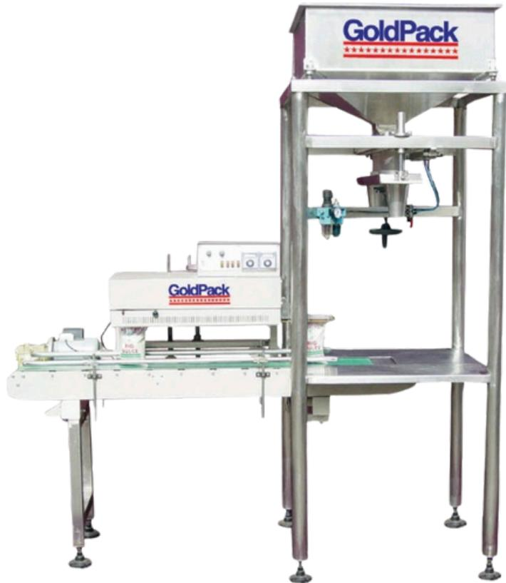
La llenadora volumétrica semiautomática por medio de tazas reciprocantes Consiste en un sistema con dos bocas dosificadoras, que por medio de tazas de dosificación volumétrica, dosifican polvos o granulados a un volumen determinado por la graduación de altura de las tazas.
