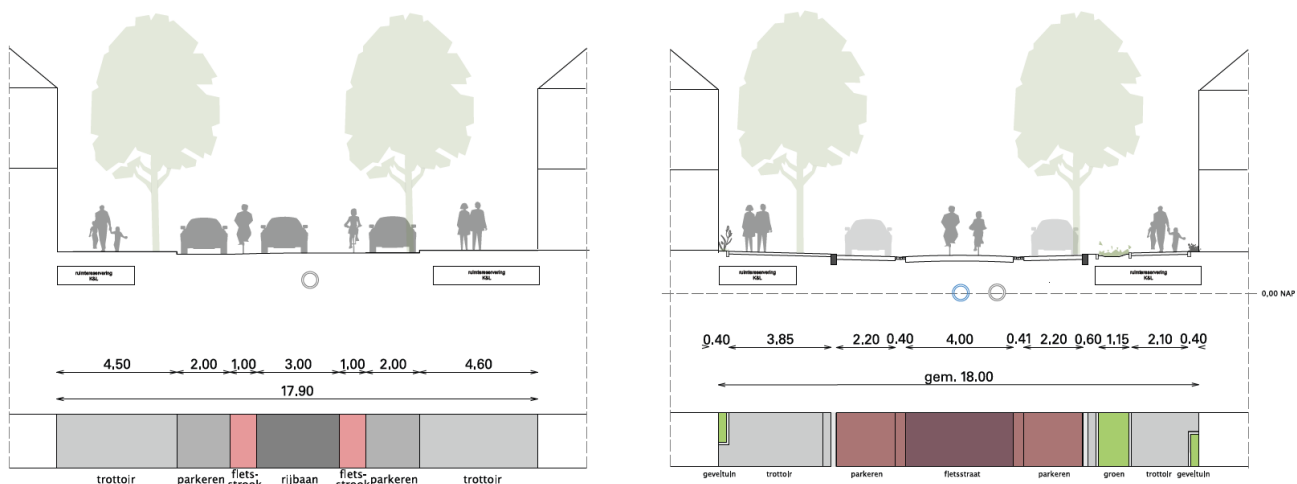
Doorsnede van de Pieter Nieuwlandstraat (ter hoogte van nummer 9) nu en in het nieuwe ontwerp
