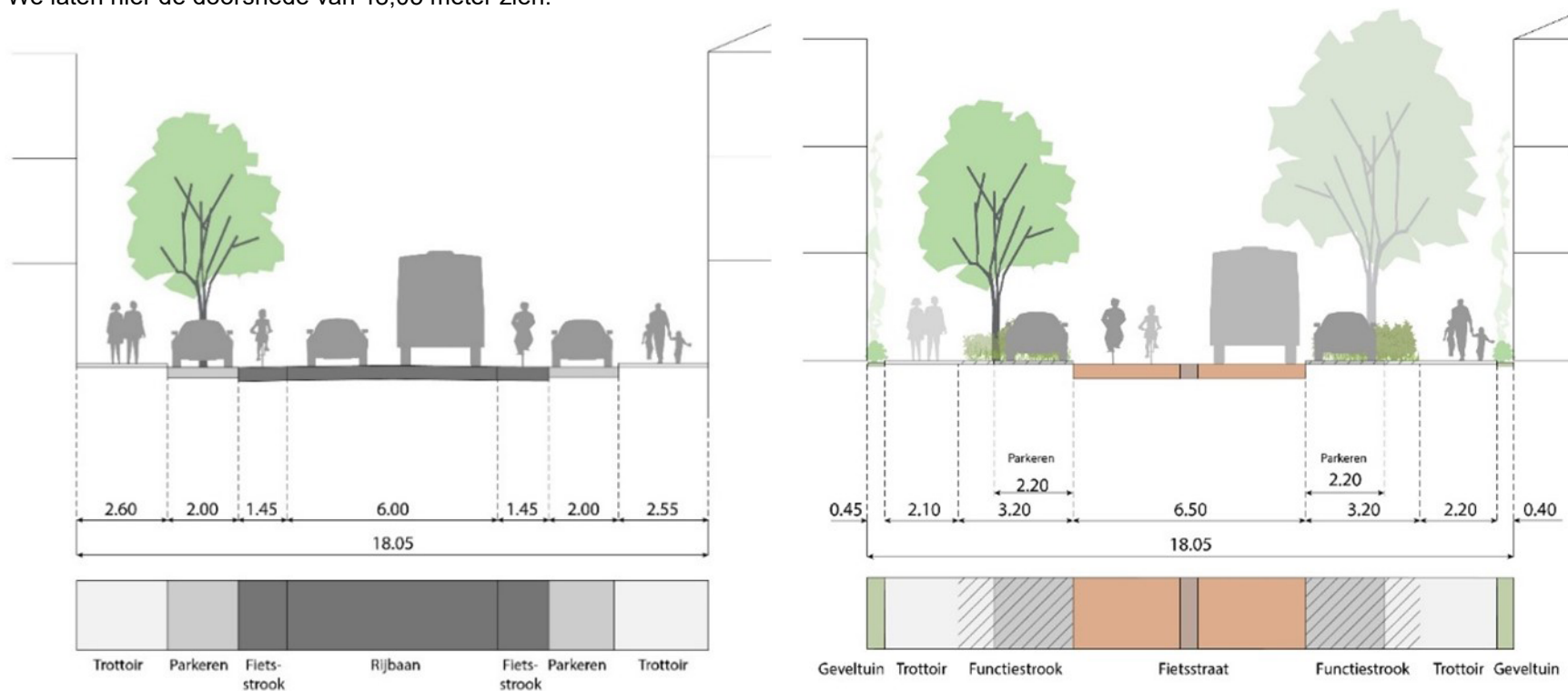
Afbeelding 2.3. Doorsnede van de Willem van Noortstraat nu en in het nieuwe ontwerp.
