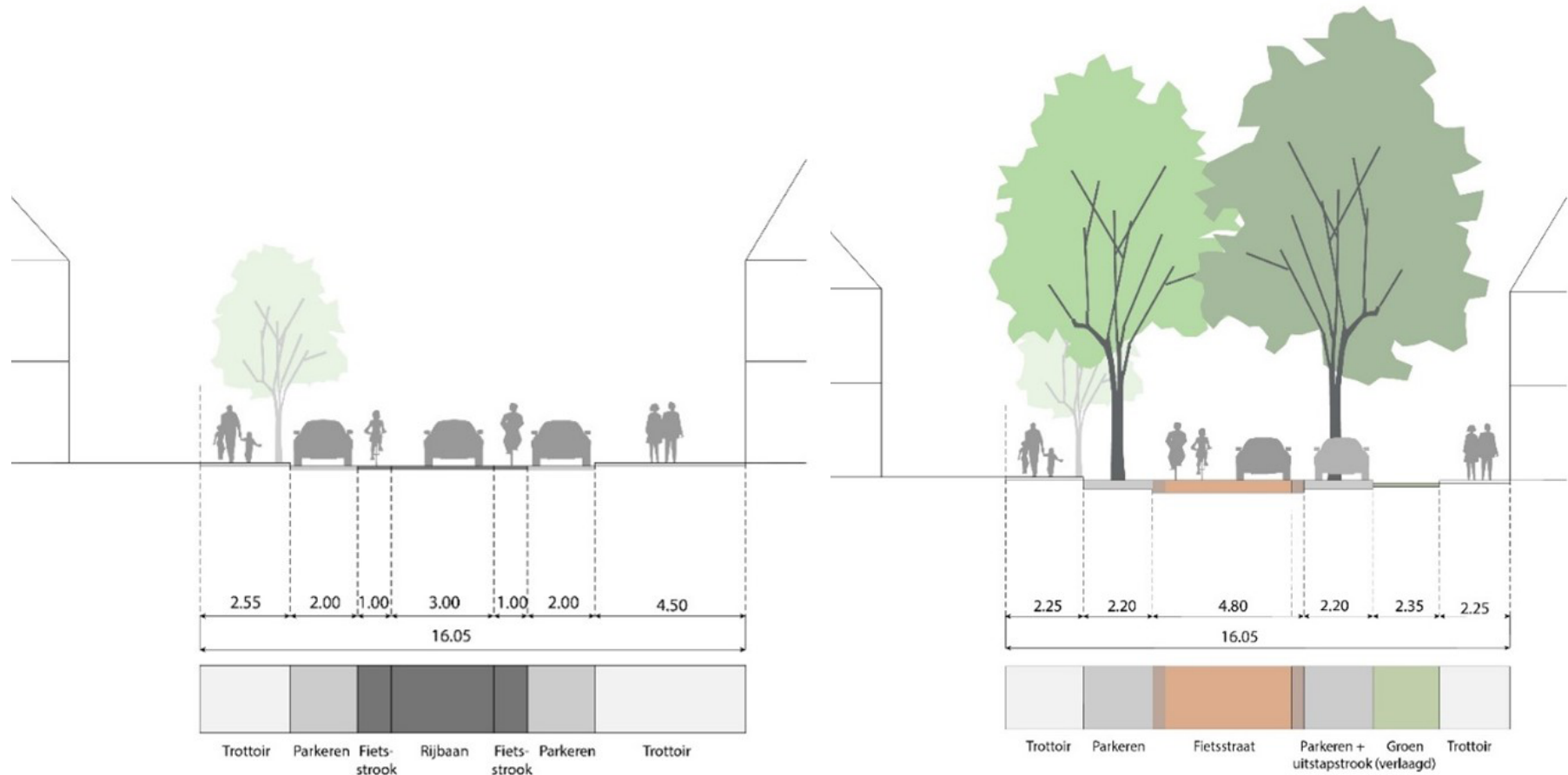
Afbeelding 4.4. Doorsnede 2 van de Pieter Nieuwlandstraat nu.
