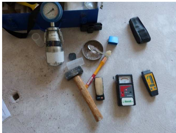
Paso 4: Medición de humedad
