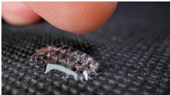
Die Oberflächenbenetzung bezieht sich auf den Grad, in dem sich eine Flüssigkeit auf einer Oberfläche ausbreitet oder an ihr haftet.
