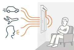
Dans les systèmes de ventilation mécanique contrôlée (VMC), le renouvellement d'air repose généralement sur des entrées situées dans les menuiseries, dispositif le plus répandu pour répondre aux exigences réglementaires. Elles garantissent un débit suffisant à travers l'enveloppe du bâtiment grâce à la différence de pression entre intérieur et extérieur.
