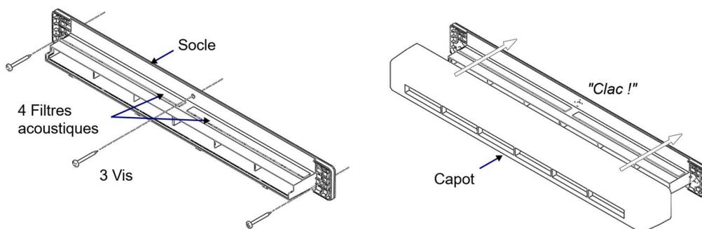
L'installation est simple : il suffit de visser le socle à l'aide de 3 vis, de positionner les filtres acoustiques, puis de clipser le capot.
