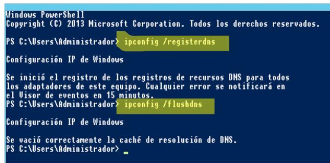
Figura 37: Aplicando las configuraciones mediante PowerShell (P1)
