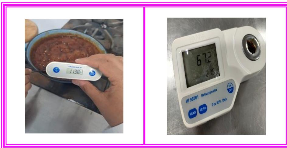
**Figura 11. Medición de los grados Brix para alcanzar “el punto” final de procesamiento de la miel.**
