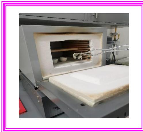
**Figura 17. Determinación de cenizas por calcinación en mufla.**
