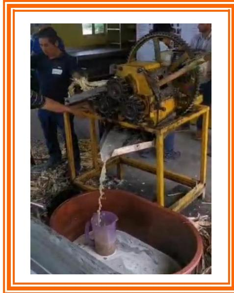
**Figura 7.** *Proceso de extracción de jugo de caña de azúcar*
