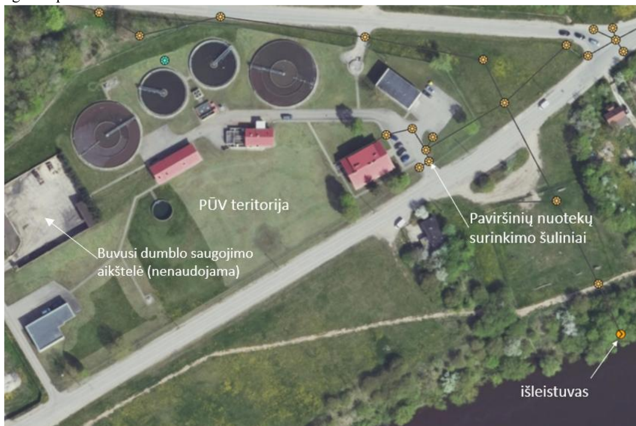
3 pav. Paviršinių nuotekų surinkimo tinklai, išleistuvai.
