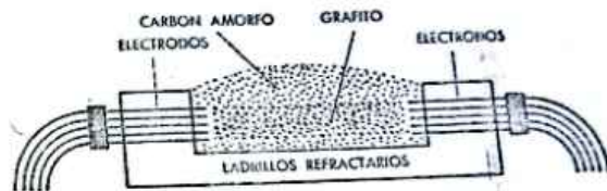
FIG. XIX-2. — HORNO PARA LA OBTENCIÓN DEL GRAFITO
