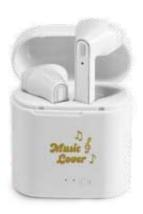
Fone de ouvido True Wireless em ABS com microfone e caixa de carregamento de 250 mAh. Possui transmissão sem fios BT v5.1, autonomia, aproximada, de 1h50, frequência 20Hz-20KHz, 98 dB e impedância de 320. Cada fone tem um botão multifunções e a caixa tem uma porta micro USB para ser carregada. Fornecido em caixa presente.
