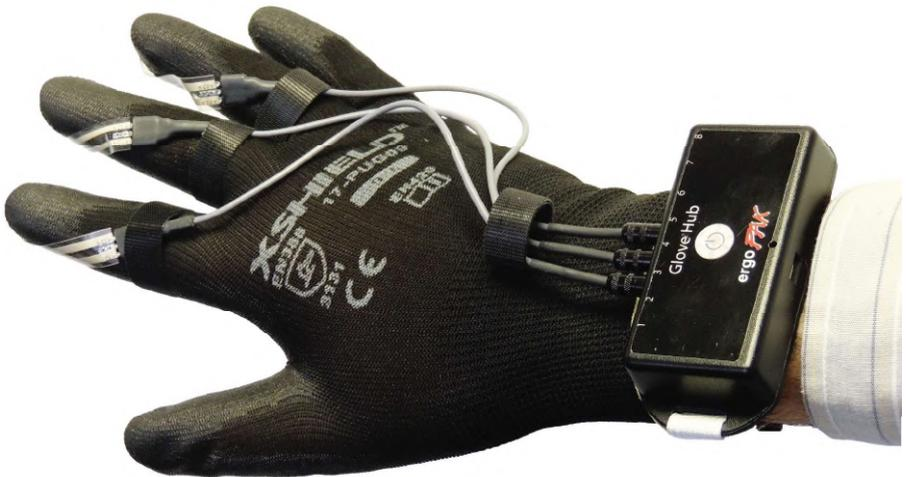
Este sistema inalámbrico permite la conexión de 1 a 8 sensores FSR, con un rango de captura de datos de hasta 25 pies. Ideal para análisis de herramientas, pruebas de productos y comparación de capacidades laborales frente a las demandas del trabajo.
