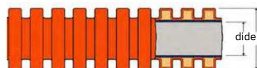
Sección longitudinal, así como el diámetro interior (di) y exterior (de).
