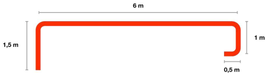
Nuestra guía fue probada utilizando **POLIFLEX** de 1/2" en una instalación de 9 metros con 3 cambios de dirección de 90° y con 5 conductores calibre 12.
