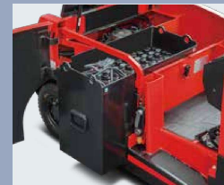
El desalojo lateral de la batería se toma como configuración estándar para reemplazar la batería fácil y rápidamente
