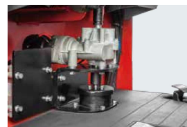
Sistema de dirección asistida electrónica (para tractor que se conduce de pie)
