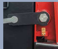
El dispositivo de bloqueo de la batería está provisto de la función de protección de seguridad. El tractor solamente puede desplazarse si el dispositivo de bloqueo se gira en su posición
