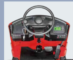
Diseño de esquema moderno con instrumentos LCD y puerto de carga USB
