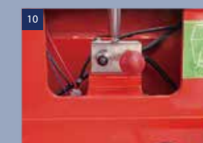
Válvula de liberación manual: cuando la máquina no se puede mover, puede empujarla después de presionar esta válvula.
