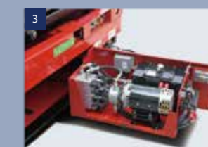
Sistema hidráulico y eléctrico
