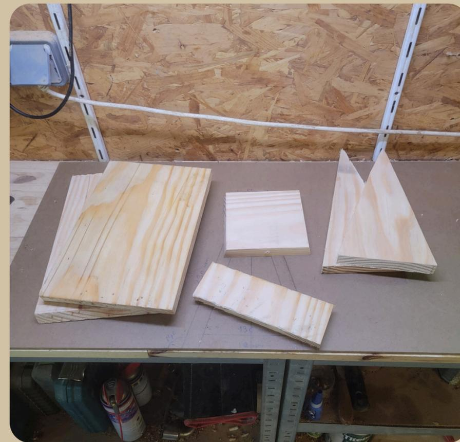
Ensuite, il faudra couper les planches en longueur et en largeur. Pour cela, utilisez une scie à main ou électrique. Pour le traçage, j'utilise une équerre et une fausse équerre.
