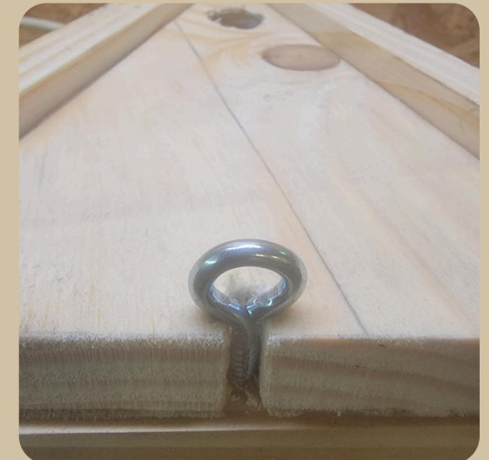
Pour le système d'ouverture c'est très simple, il suffit d'encaster la façade dans les tourillons et de tourner le crochet pour qu'elle tienne.
