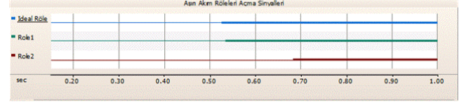
Şekil 4. Farklı R_w sekonder devre empedanslarına sahip akım transformatörü akımlarının aşırı akım koruma fonksiyonu açma süreleri üzerindeki etkisi ( R_{wAT1}=0,5\Omega , R_{wAT2}=5\Omega )
