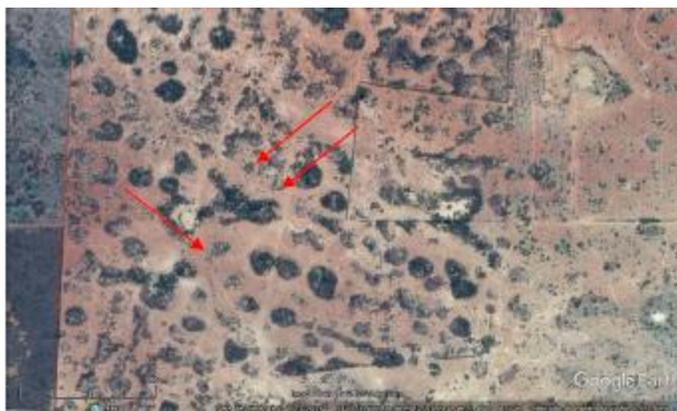
Exemplos de feições circulares com diâmetros de 10 a 100 m e depressão central inferior a 1 m, por provável dissolução, mas que não apresentam nenhum outro estágio de evolução cárstica.
